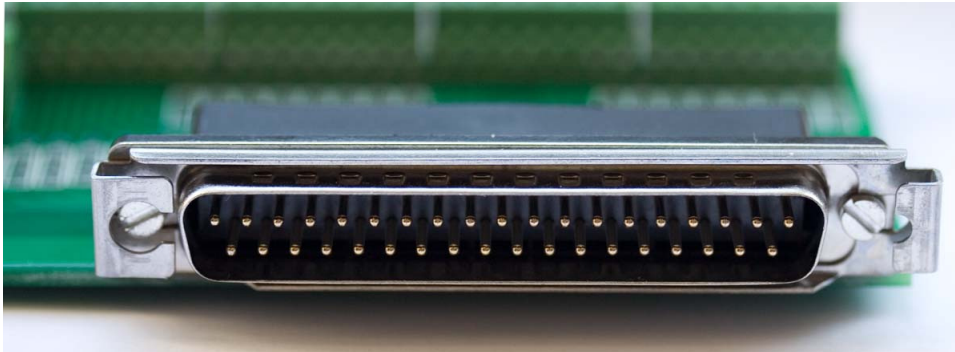
Fig 3: DS32 connector met slidelock in de “unlocked” positie
