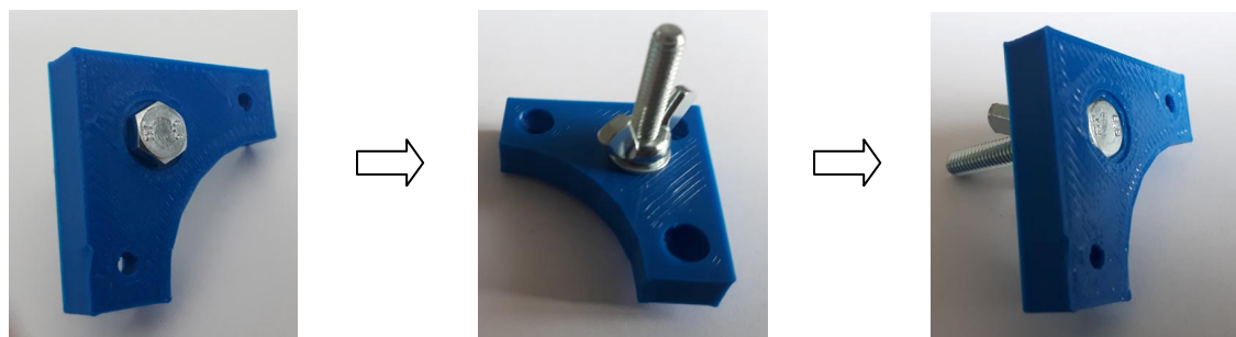
Abbildung 2: Sechskantschraube im Grundblock montieren
