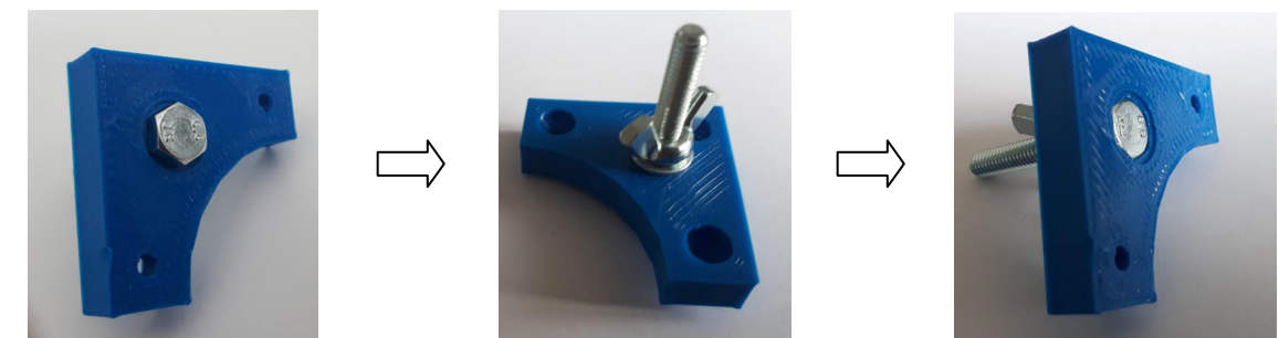
Abbildung 2: Sechskantschraube im Grundblock montieren
