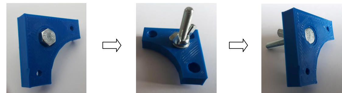
Figuur 2: Monteren zeskantbout in basisblokjes
